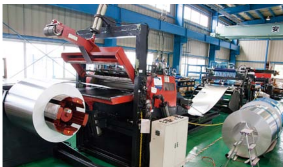
コイル材からレバラー、シャーリングとつながり、材料を切り出す
