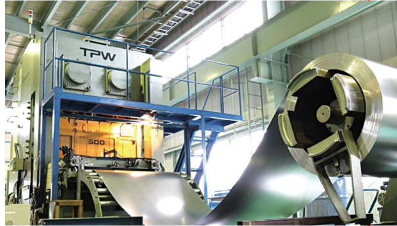
規格品のパンチングメタルを加工するダブルクランクプレスTPW-500 (500トン)
