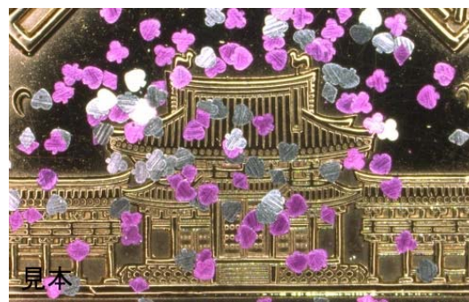
図4. 十円硬貨の建物部分とトランプ柄パウダー(各柄の横幅は約500 \mu\text{m} )
