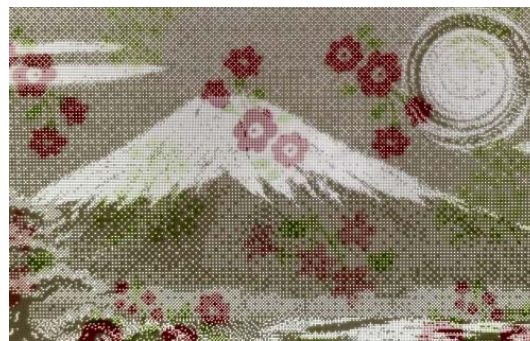
図2. 図1の試作品に透過光(バックライト)をあてて浮かび上がった富士山の画像(白い部分が孔の透過光による光輝部)
