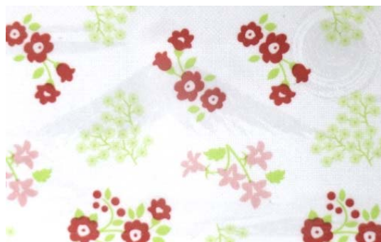
図1. 表面印刷を施したアルミ箔に対して丸孔(直径150 \mu\text{m} )で開孔した試作品の反射光(室内光)での外観画像
