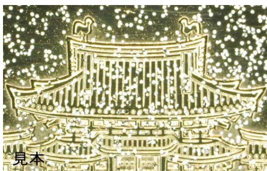
図3. 十円硬貨の屋根部分と円盤状パウダー(円盤の直径は約100 \mu\text{m} )
