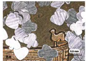
十円硬貨の鳳凰堂部分とトランプ柄平面状物質 (サイズ約 500 μm、厚さ 15 μm、材質：アルミ)
