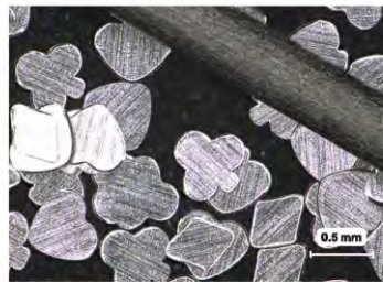
トランプ柄平面状物質 (サイズ約 500 μm、厚さ 15 μm、材質：アルミ) とシャープペンシル 0.5 mm 芯
