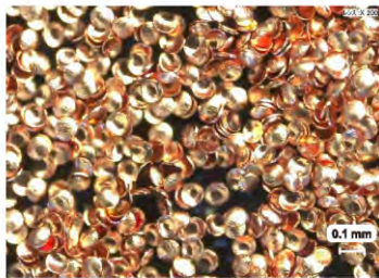
円盤状パウダー (直径約 100 μm、厚さ 8 μm、材質：銅)
