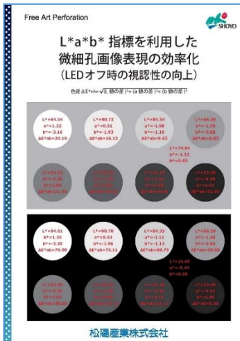
図3. 各種明度の開孔部と未開孔部の 組み合わせ時の視認性比較
