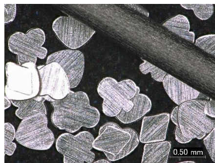
図6. 平面状金属パウダーの例 (トランプ柄) [サイズ約 500 \mu\text{m} 、厚さ 15 \mu\text{m} 、材質: アルミ、 比較はシャープペンシル 0.5 mm 芯]
