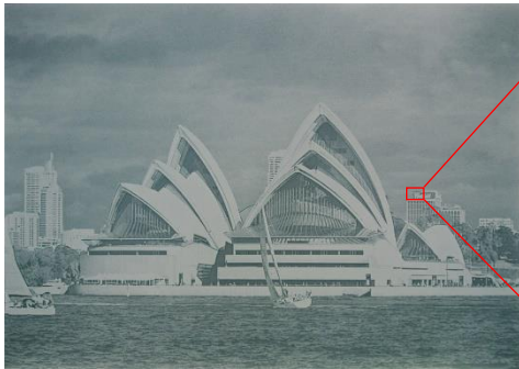
図1. オペラハウス画像 (LED オフ時) [約 137 万 2 千個の丸孔による描画、 孔の大きさ: 直径 100 \mu\text{m} (0.1 mm) ~ 200 \mu\text{m} の 11 種類]
